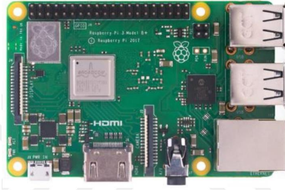
Şekil 2.7: Mini PC'nin Fotoğrafi (Raspberry Pi 3 Model B+)
