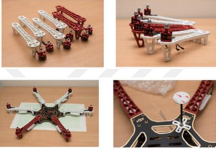
Şekil 3.14: İHA Montaj Aşamaları
