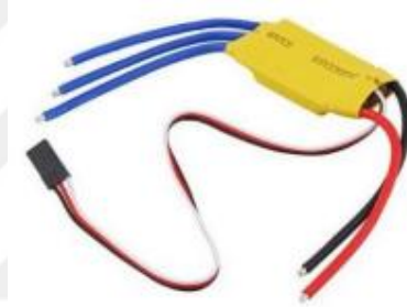
Şekil 2.29: Kullanılan 30A'lik ESC Modeli
