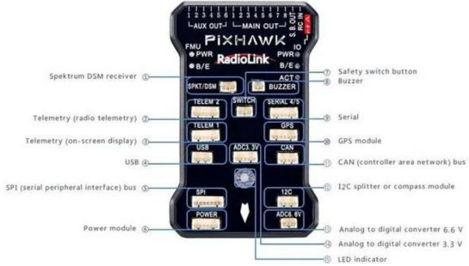
Şekil 2.21: (Devamı) Pixhawk Uçuş Kontrolörü Üstten Görünüm ve Bağlantı Noktalarının Görünümü
