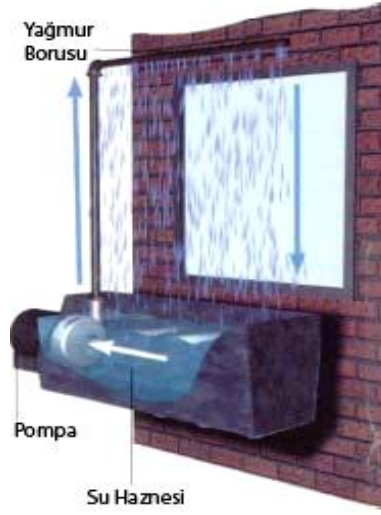
Şekil 3.31: Yağmur Efektini İçin Düzenek
