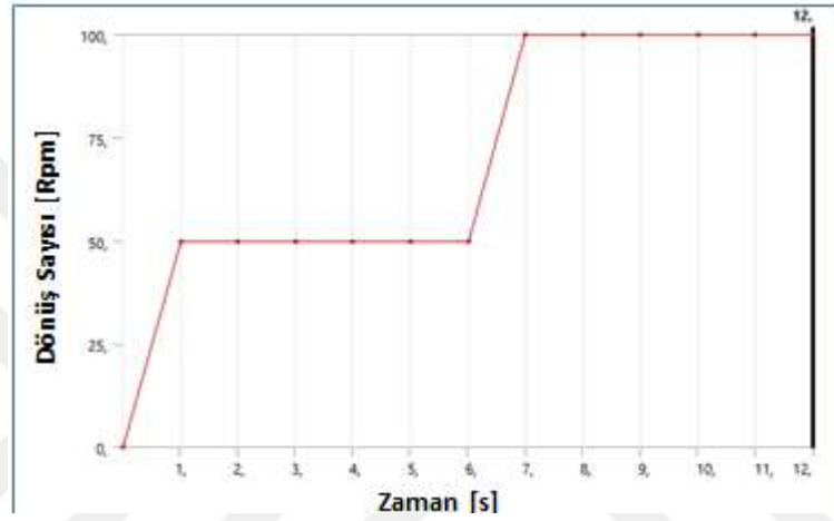
Şekil 6.24: Bıçaklı palet grubunda motor milinin 50 devir/dakika ve 100 devir/dakika dönüş değerlerinde çalıştığı zaman aralıklarının gösterimi
