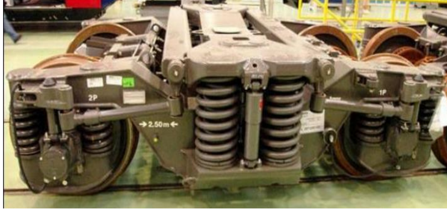
Şekil 2.2: Çift Akslı Konvansiyonel Yolcu Vagonu Bojisi
